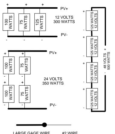
LARGE GAGE WIRE #2 WIRE SPLICE LARGER GAGE WIRE IF REQUIRED
