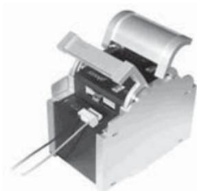
Abra a tampa superior da MCU. Conecte os condutores conduzindo os ao conector verde(cinco terminais) e, em seguida, conecte os fios à bateria observando a correta polaridade. Para evitar o aparecimento de qualquer tensão nos condutores durante a instalação, conecte primeiro a MCU e depois a bateria. Observe o comprimento recomendado para este condutor mÍn. de 30 cm até máx. De 100cm) e a bitola de 2.5 mm<sup>2</sup>. Feche a tampa superior.
