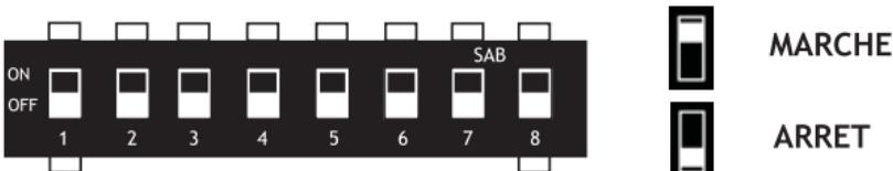
Le commutateur DIP-5 est employé pour la sélection de mode du MPS.
