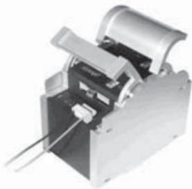
Öffnen Sie die obere Abdeckung der MCU. Um spannungsfrei zu arbeiten, schließen Sie zuerst die Versorgungskabel an die MCU (grüne, fünfpolige Klemmleiste) und dann polrichtig an die Batterie an. Achten Sie auf die Kabellänge (mind. 30 cm bis ca. 100 cm) und eine Kabelstärke von je 2.5 mm<sup>2</sup>.
