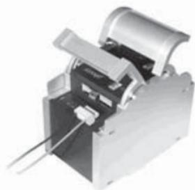
Ouvrez le couvercle en haut de la MCU. Branchez les câbles reliés à la borne verte (5 broches) puis branchez les câbles à la batterie en respectant les pôles. Afin d'éviter un choc électrique provenant des câbles, commencez par brancher la MCU puis ensuite la batterie. Respectez la longueur de câble recommandée (min. 30 cm, max. environ 100cm) ainsi que diamètre de 2.5 mm<sup>2</sup>. Refermez le couvercle supérieur.
