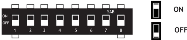
El interruptor DIP 5 se utiliza para la selección del modo MPS.
