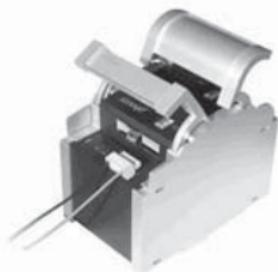
打开MCU控制器的上保护盖。将线缆连接到绿色端子上（五针）并且按照正确的极性把线缆连接到蓄电池上。为避免线上产生任何电压，首先连接MCU然后是蓄电池。注意推荐线长为（最小30厘米最长100厘米）推荐线径为2.5平方厘米。
