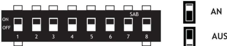
Der DIP-Schalter 5 definiert die Art der Steuerung der einzelnen Systemkomponenten.
